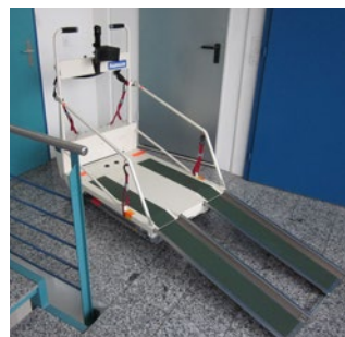
Rampen ausfahren; Raupe auffahrbereit
