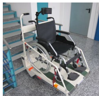
Treppenraupe auf Rädern vor Treppe fahren
