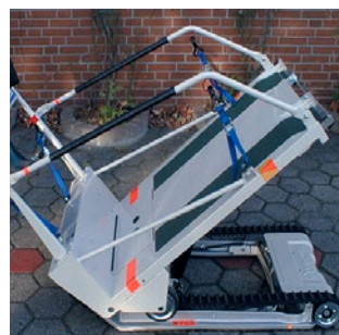
Plattform anheben; Raupe auf die Treppe fahren
